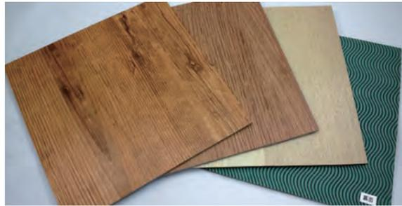
裏面に滑り止め加工を施すことで、接着剤不要の施工が可能となり、工期の短縮が図れます。OAフロアにも対応しております。
