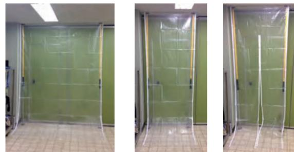
自由に組み合わせてご使用できます。マジックテープでシート同士をジョイントしますので、簡単に気密性の高い間仕切りができます。
